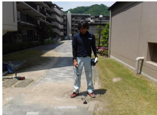
漏水探知機にて路面音聴
