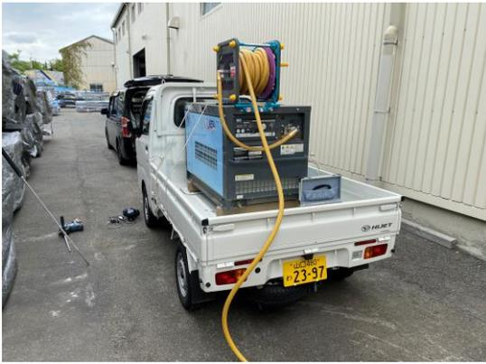
コンプレッサーを接続し、圧縮空気を充填
