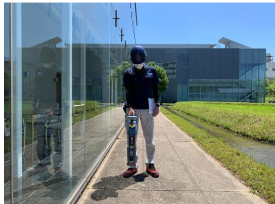
埋設管の位置を確認
