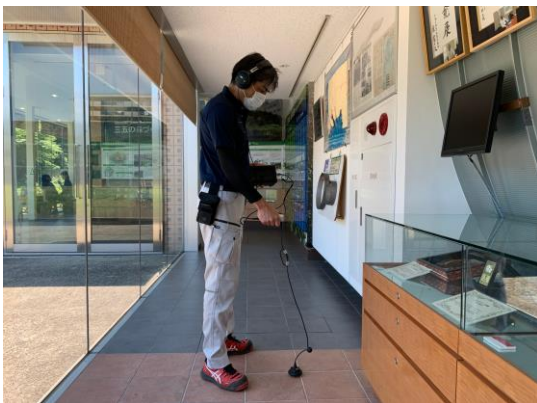
漏水探知機にて路面音聴
