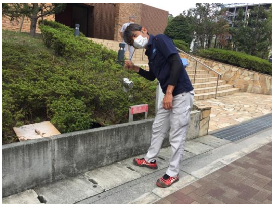
音聴棒にて送水口の音聴
