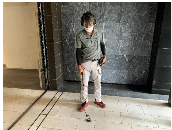
漏水探知器による音聴
