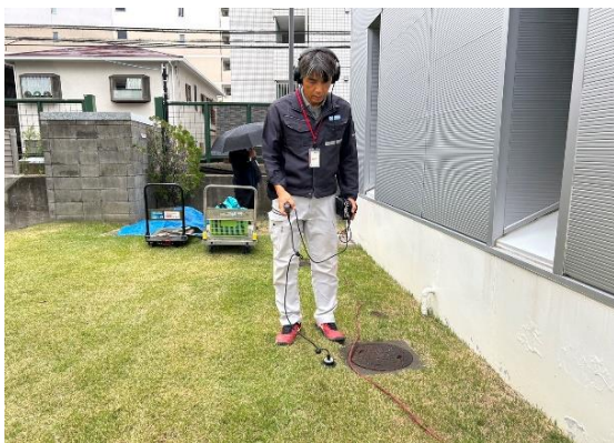
漏水探知器による音聴
